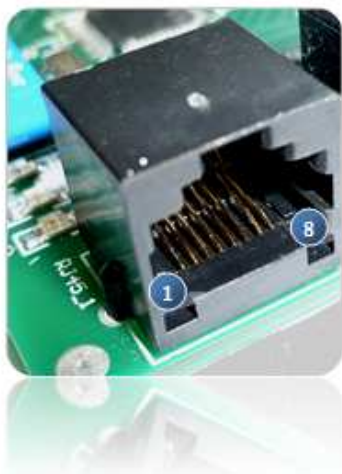
Zdjęcie 2, Tabela 9. Wyprowadzenia złącza RJ45 do podłączenia sieci RS485
