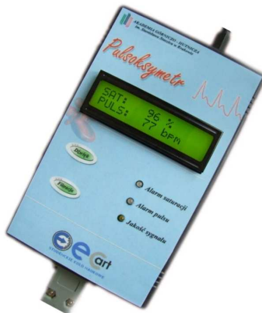
Rys. 4 Zdjęcie skonstruowanego pulsoksymetru.
